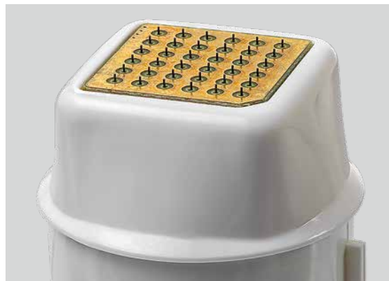
3. Наконечник Gen36 под увеличением, рабочая площадь — 1,5 x 1,5 см, толщина игл — 150 мкм
